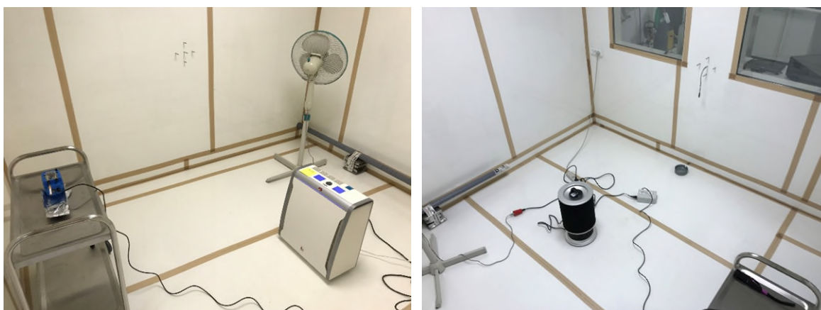
Figur 1. Forsøgsopstilling med AeroGuard 4S vist på billedet til venstre og AeroGuard Mini vist på billedet til højre.
